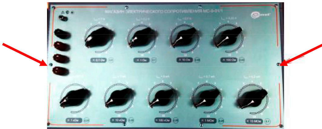
Рисунок 2 – Схема пломбировки от несанкционированного доступа магазинов электрического сопротивления.
